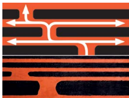
Fig. 1. Distribuția gazelor, a aerului fierbinte și a vaporilor de apă sub suprafața membranei. Suprafața totală a canalelor de ventilație este de 50% din suprafața totală a membranei.
